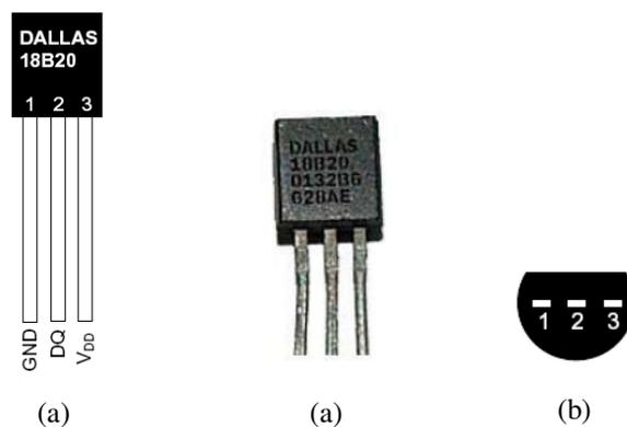
Figure 3.14 DS18B20 views (a) front side (b) bottom side
